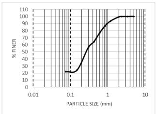
FIGURE 1A: PARTICLE SIZE DISTRIBUTION OF IOT
