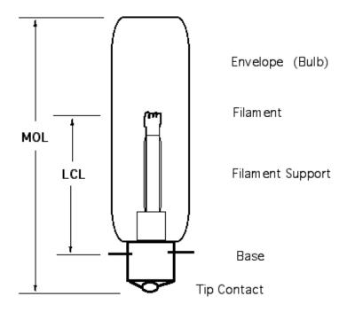
Figure 2.7: A detail halogen tungsten lamp.
