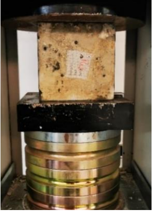
Şekil 4. ACT ikameli betona basınç dayanımı deneyi yapılması
