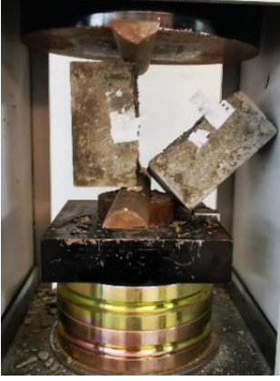
Şekil 3. ACT ikameli betona yarmada çekme dayanımı deneyinin yapılması
