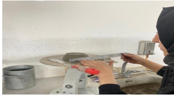
Şekil 5. Üretilen harç numunelerine uygulanan yayılma tablası deneyi
