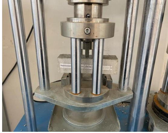
Şekil 6. Üretilen harç numunelerine uygulanan eğilme deneyi
