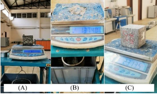
Şekil 1. ACT ikameli betona Arşimet deneyinin yapılması, Doygun yüzey kuru ağırlık (A), Su içerisindeki ağırlık (B), Etüv kurusu ağırlık (C)
