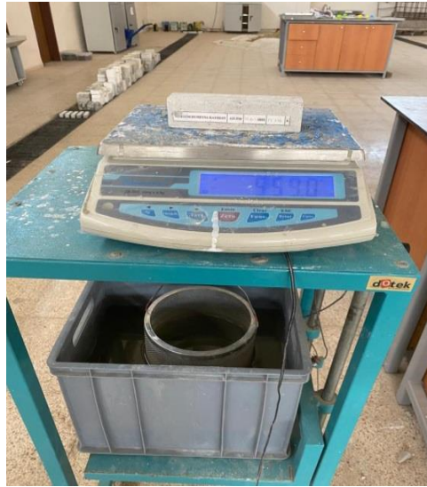
Şekil 7. Harç numunelerine uygulanan Su emme, Porozite ve Birim Hacim Ağırlık Deneyleri
