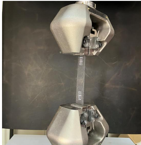
Şekil 2.1. Karbon/epoksi numuneye çekme testi uygulanması.
