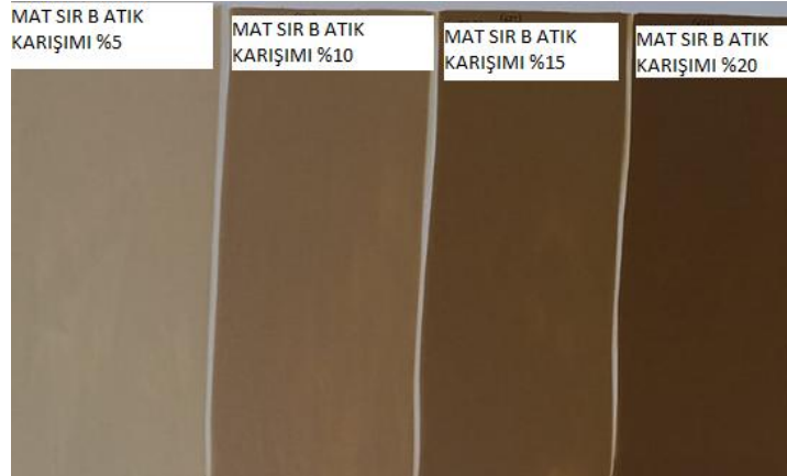
Şekil 2.2. Atık karışımı uygulanmış duvar karosu (A) mat sırlı karoların pişme sonrası yüzey görüntüleri
