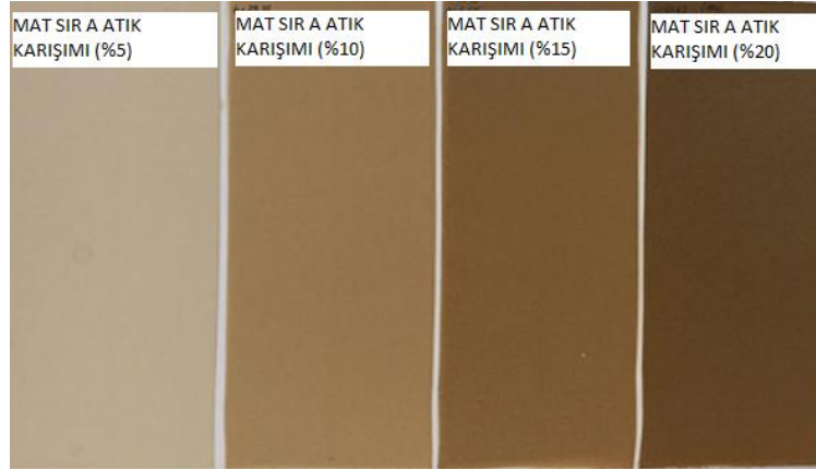
Şekil 2.2. Atık karışımı uygulanmış duvar karosu (A) mat sırlı karoların pişme sonrası yüzey görüntüleri
