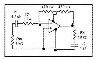
FIG. 3.2 VOLTAGE AMPLIFIER
