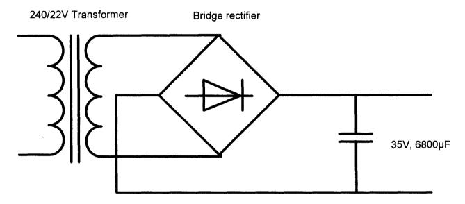
Fig. 3.1 AC Rectifier Circuit
