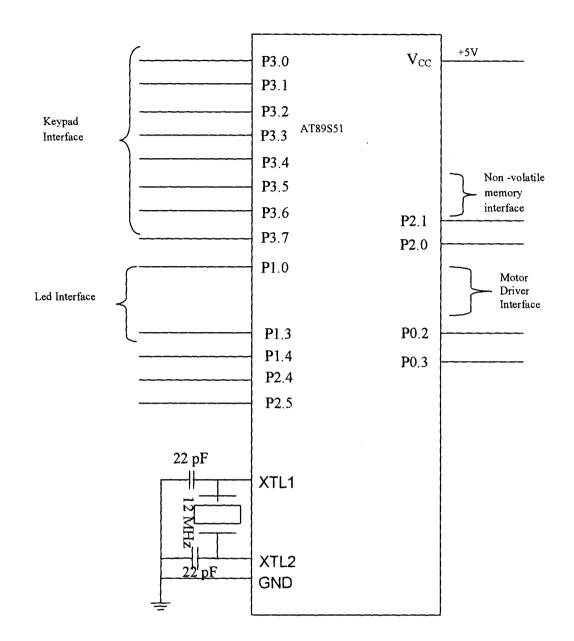
Fig. 3.4: AT89S51 pin interface [3].
