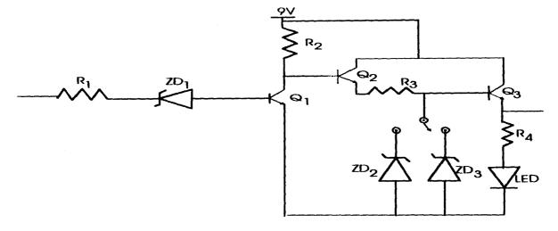
fig 2.1 (d) The switching circuit.
