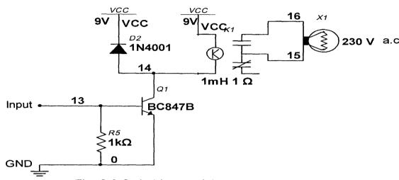
Fig: 3.9 Switching module
