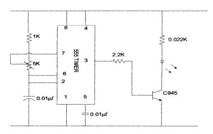
**FIG 3.5 TRANSMITTER CIRCUIT**
