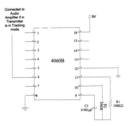
Fig 3.4.1.1.3 The Pulse Generator
