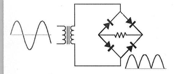
Fig. 3.4 Bridge rectifier
