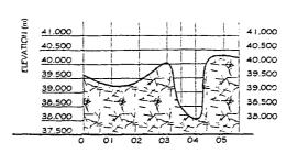
GULLY CROSS-SECTION AT CHAINAGE 0+570 SCALE - V-1:50 H - 1:100
