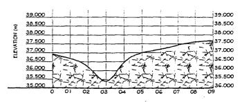
GULLY CROSS-SECTION AT CHAINAGE D+-700 SCALE - V-1:50 H - 1:100
