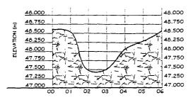
GULLY CROSS-SECTION AT CHAINAGE 0+020 SCALE - V-1:50 H - 1:100
