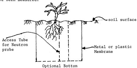
Fig. 2.3.1 A non - weghing Lysimeter.
