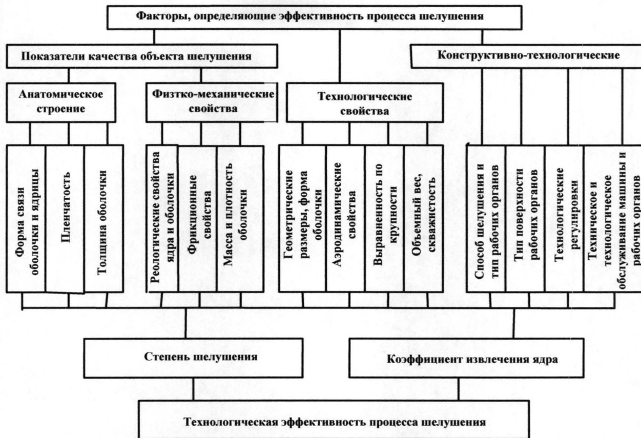
Рис.1.13. Схема структурной связи факторов, влияющих на технологическую эффективность процесса шелушения
