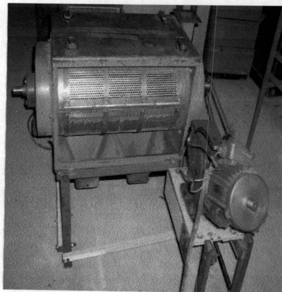
Рис.3.6. Установка лопастного типа для исследования процесса удаления кожуры плода арахис: 1 – зазор; 2 – лопатка; 3 – стойка; 4 – рама; 5 – неподвижный цилиндр.
