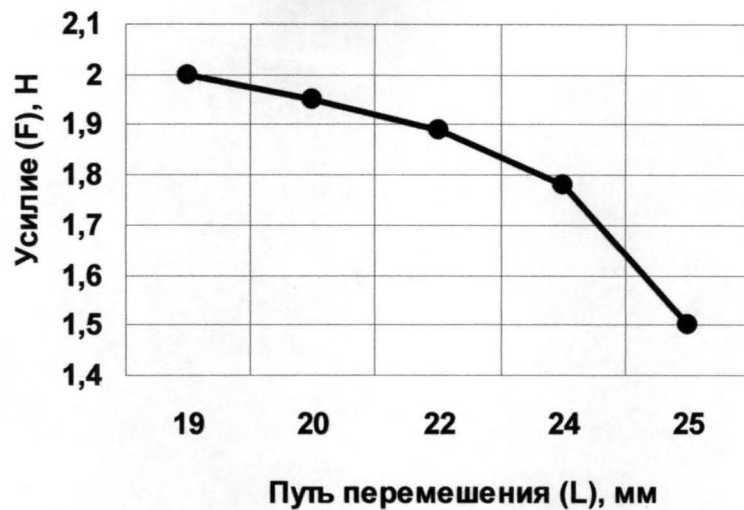
Рис. 4.6. Усилия разрушения кожуры плода арахиса сорта «Kampala» в зависимости от пути перемещения
