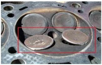
Plate XX: bent valve (www.ssch.com.au)
