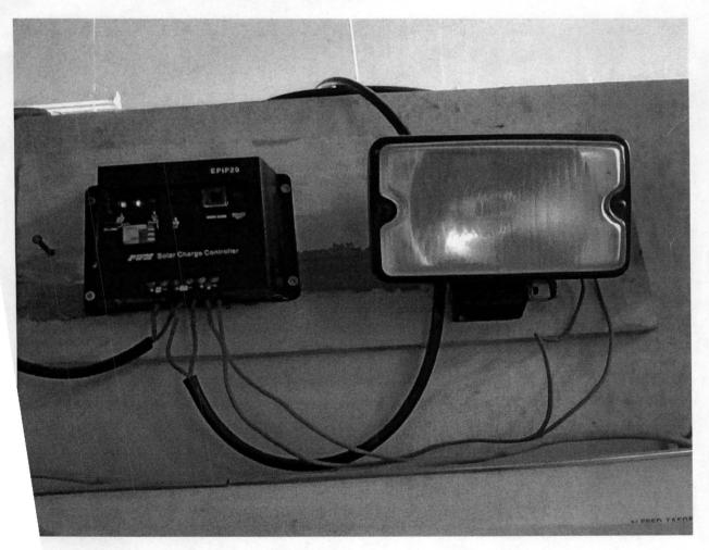
SOLAR CHARGE CONTROLLER AND 30 WATTS BULB
