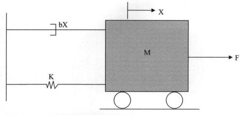
FIG. 3.4 SIMPLE MASS, SPRING AND DAMPERS
