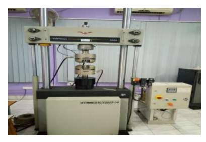
Plate VI: Instron 8862 tensile machine
