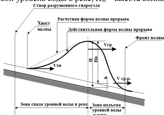
Рис. 1. Схематический продольный разрез волны прорыва [4]
